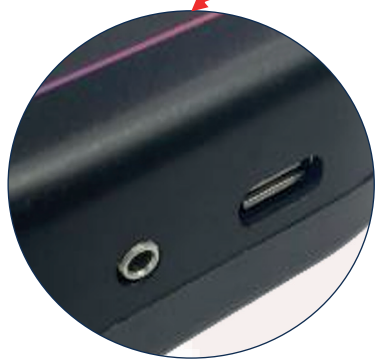
Conector do teste de faísca e USB para recarregar a bateria
